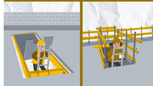
► Installez un plancher de protection sur toute la surface de la trémie, permettant le passage des matériaux encombrants et muni d'une trappe pour le passage des personnes.
