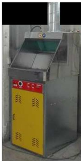
**Système fermé automatique de lavage des pistolets à
