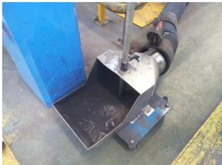
**Capteur non fixé à l'échappement**, il sera d'une taille suffisante, de l'ordre de 30 x 30 cm, pour capter l'intégralité du flux des gaz d'échappement compte tenu de son éloignement de l'échappement permettant l'introduction de la sonde. Il est nécessaire que celui-ci ne soit pas placé à plus de 30 cm dans l'axe d'émission des gaz d'échappement (voir exemple). Il est recommandé qu'il soit positionné sur roulettes et réglable en hauteur.
