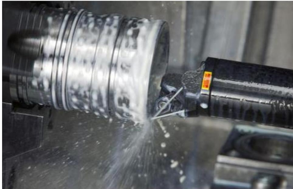
Permet de chasser les copeaux et dans certains cas d'augmenter les vitesses de coupe. La pression du fluide est généralement supérieure à 70 bars.
