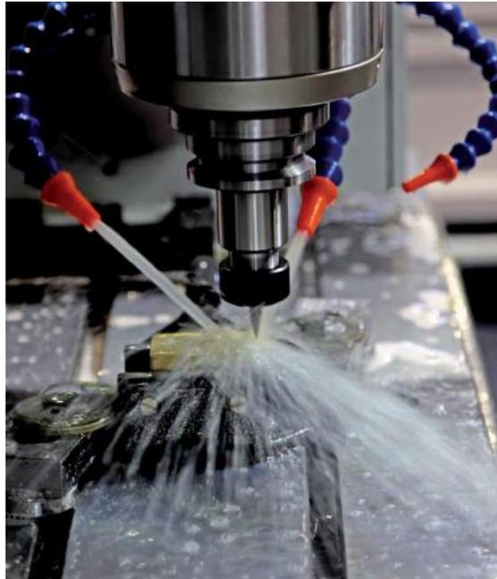
Permet de refroidir la pièce à usiner et d'évacuer les copeaux.
