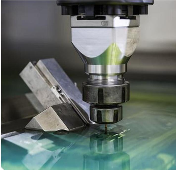
L'électroérosion par enfonçage, appelée aussi EDM, est un procédé d'usinage qui consiste à enlever de la matière dans une pièce en utilisant des décharges électriques.
