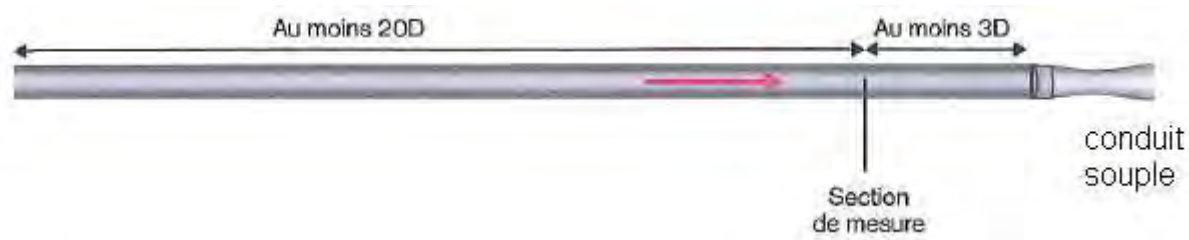
Figure 1 : Configuration de la mesure avec un conduit rigide venant remplacer le dispositif de captage.
